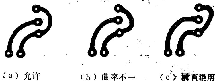
图 5-17 曲线导线的要求
